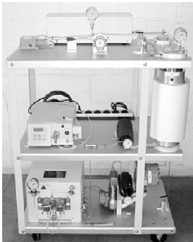
Рис. 1. Система сверхкритической флюидной экстракции SFE-100M1-2-FMC50 производства Thar Instruments, Inc. (США)
