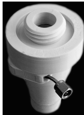
Рис. 2. Внешний вид сепаратора, полученного методом 3D-печати
