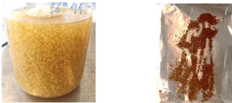
Рис. 4. Внешний вид лигнина: a — осажденного в воде; b — после сушки
