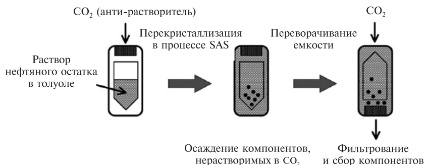
Рис. 7. Принципиальная схема процесса осаждения осадка методом SAS с использованием субкритического \text{CO}_2 ( P = 25,5 МПа, T = 25^\circ\text{C} ) [61]
