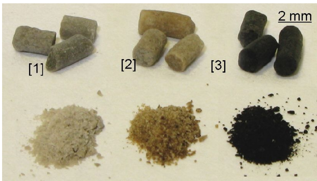
Рис. 2. Фотографии образцов Pt-Re/ \gamma -Al 2 O 3 катализатора (А): 1 - исходный; 2 - обработанный в O 3 /СК-CO 2 при 50° С; 3 - закоксованный
