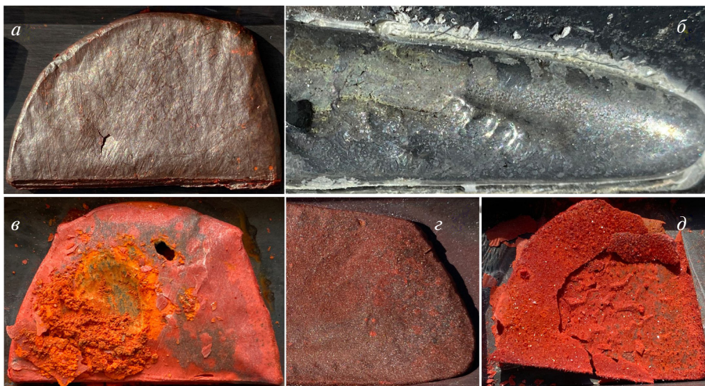
Рис. 3. Фотографии образцов свинца, окисленного в среде кислорода O 2 (а); H 2 O (б); смесей H 2 O/O 2 (в, г) и H 2 O/H 2 O 2 (д)
