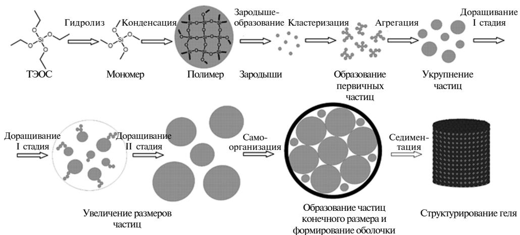
**Рис. 1.** Схема образования наночастиц  $\text{SiO}_2$
