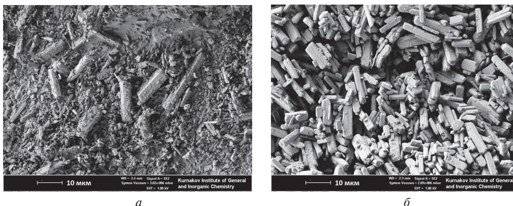
Рис. 3. СЭМ-фотографии левофлоксацина, микронизованного методом SAS при давлении: а — 7,5 МПа, б — 10,0 МПа
