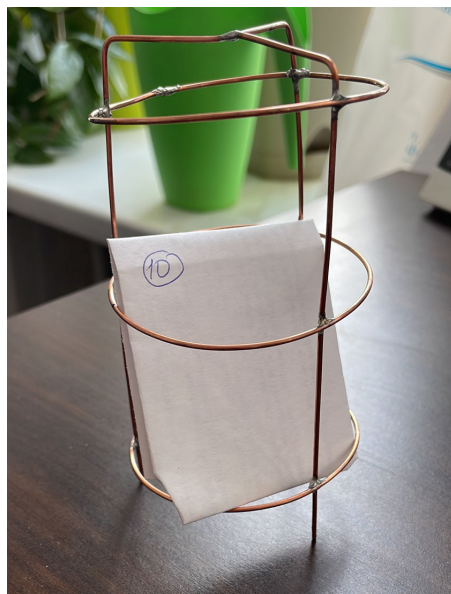
Рис. 3. Крепление бумажных носителей в рамке
