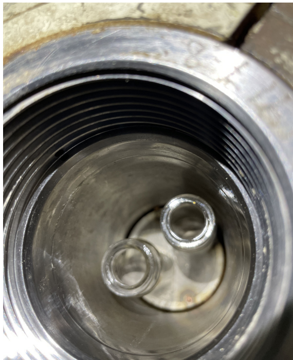
Рис. 2. Размещение стеклянных флаконов с культурами грибов в сосуде высокого давления
