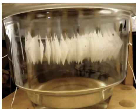
Рис. 6. Выращивание культуры Aspergillus niger на образцах бумаги
